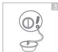
หลังจากนำไหลออกหมดแล้ว ให้ติดตั้งสายท่อระบายน้ำอีกครั้ง
