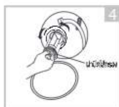
เปิดฝาปิดตัวกรองด้วยการหมุน กวนเข็มนาฬิกา
