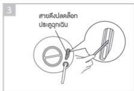
3. ใช้เครื่องมือสอดเข้าที่ห่วงดึง แล้วดึงลงด้านล่าง เพื่อปลดล็อกประตูเครื่อง
