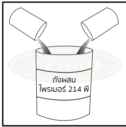
น้ำยาฟอร์โรกริต 214 พี 1 ลิตร กับน้ำสะอาด 3 ลิตร
